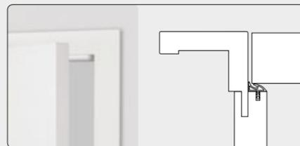
Bei der stumpfen Ausführung bildet das Türblatt eine annähernd bündige Ebene mit der Bekleidung.
