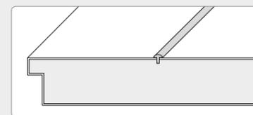
Die in verschiedenen Oberflächen erhältlichen Linea Keder werden auf das Türblatt aufgelegt. Je nach Türoberfläche und gewählter Applikationsfarbe entstehen flexible Gestaltungsmöglichkeiten zur optischen Aufwertung des Türblattes.
