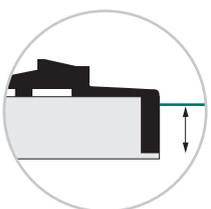
TOPIC GFK-Schwelle für den optimalen Bodenanschluss innen. Die Anschlagsschiene wird individuell gekürzt und auf den fertigen Fußboden aufgesetzt.
