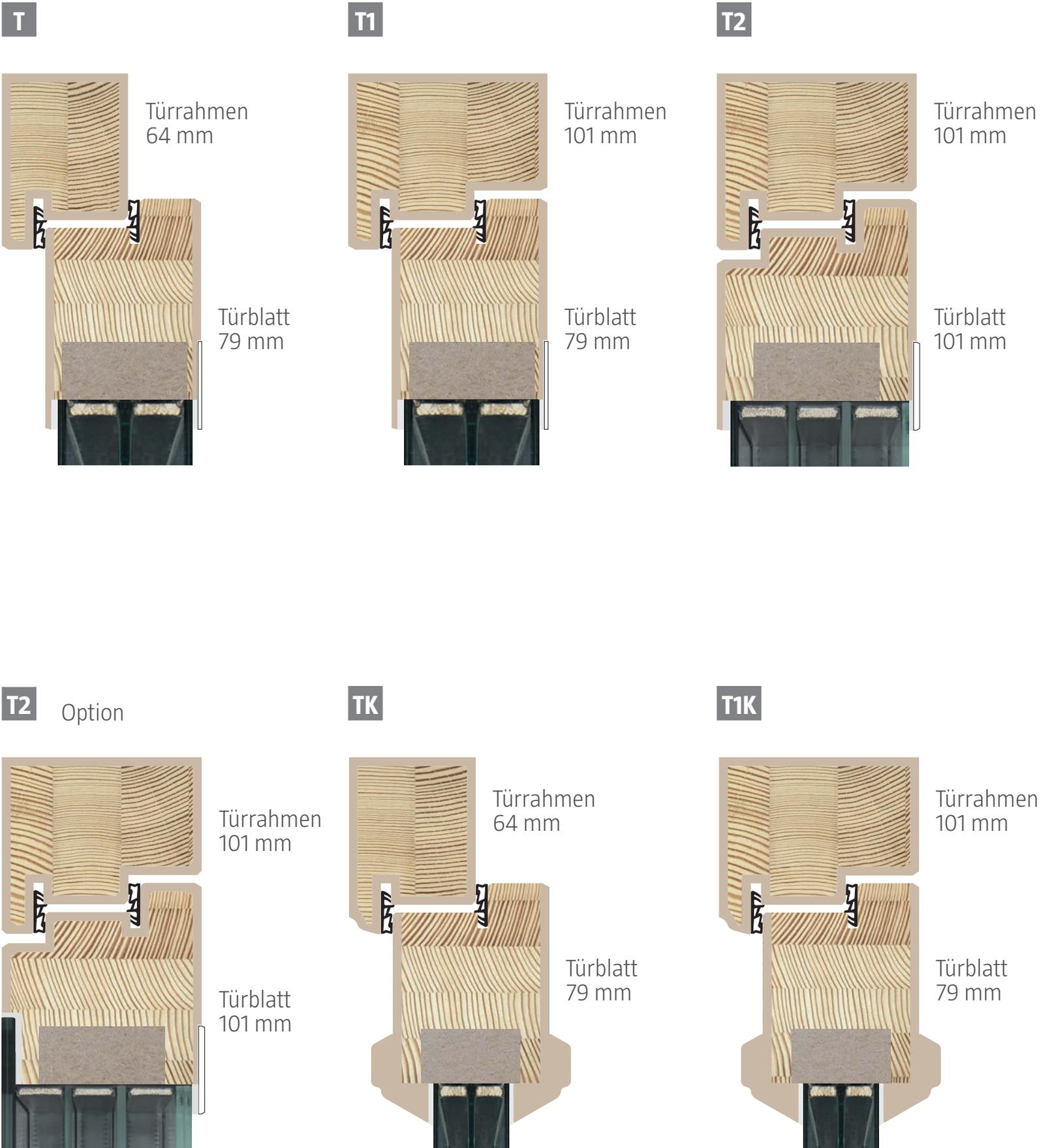
Hinweis: das Modell A484 steht in den Aufbauten T, T1 und T2 zur Verfügung
